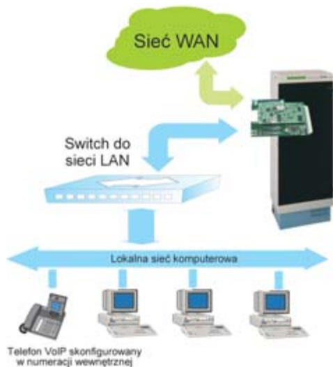
Konfiguracja podłączenia centrali Slican CCA 2720 do sieci lokalnej i rozległej
