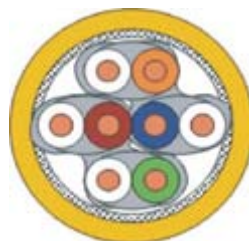
Rys. 3. Przekrój kabla CSTP (podwójny ekran) kat. 7 (1200 MHz)
