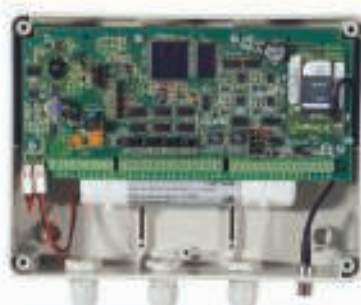
Moduł telemetryczny GPRS
