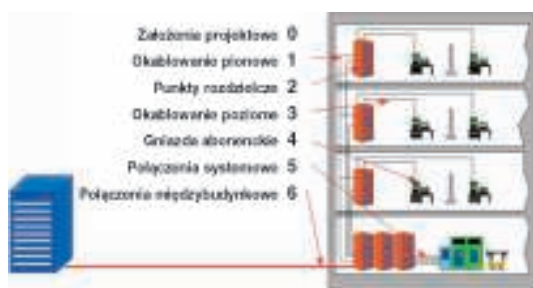
Rysunek 1. Elementy systemu okablowania strukturalnego
