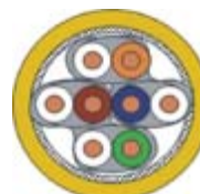
Rys. 3. Przekrój kabla CSTP (podwójny ekran) kat. 7 (1200 MHz)
