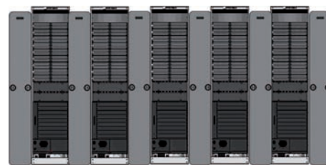
Rys. 3. Zestaw 5 ram 19" oraz 6 prowadnic pionowych wyposażonych w drzwi przednie
