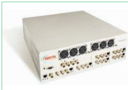
Rys. 5. Modułowa stacja bazowa PacketWave 1000
