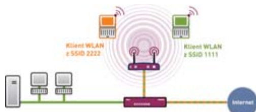
Rys. 3. Separacja użytkowników różnych sieci za pomocą Multi SSID i WLAN
