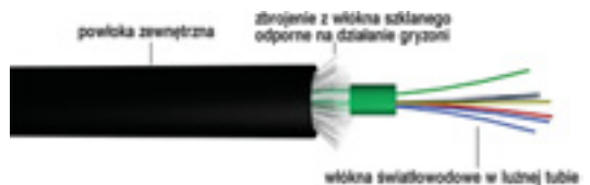
Rys. 3. Kabel ogólnego stosowania zalecany do zastosowań ziemnych
