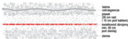
Rys. 1. Sposób instalacji kabla bezpośrednio w ziemi
