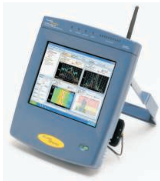
Przenośne analizatory, takie jak OptiView Series III, są nieodzownym narzędziem do rozwiązywania problemów w obrębie sieci lokalnej
