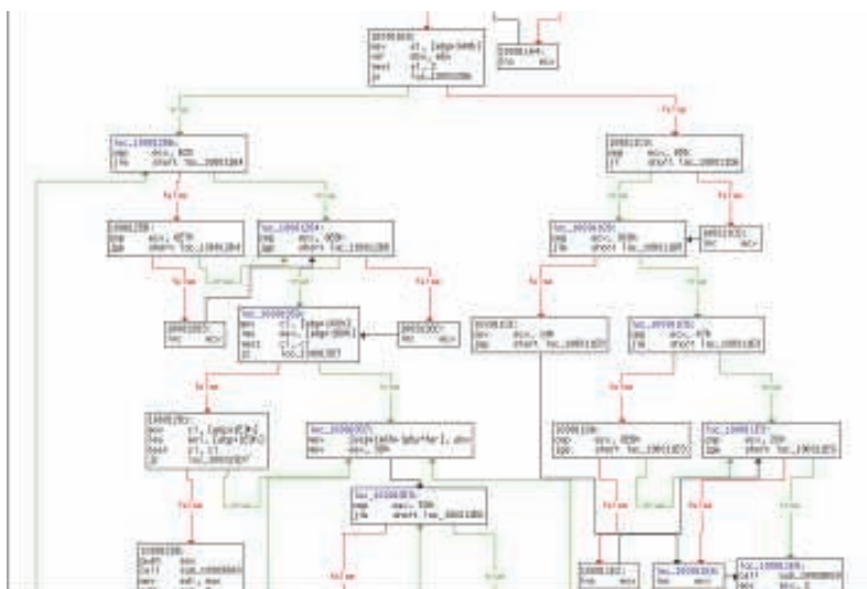
Rys. 3. Zaciemniony kod w trojanie Trojan-Dropper.Win32.Small.ue
