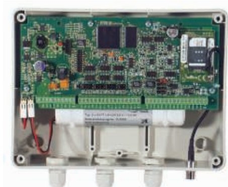
Moduł telemetryczny GPRS
