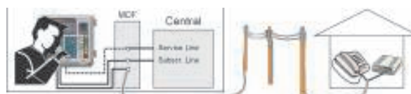
Rys. 2. Podłączenie linii abonenckiej do ALT 2000 MDF dla pomiaru widmowej gęstości mocy (tester w stanie wysokiej impedancji)
