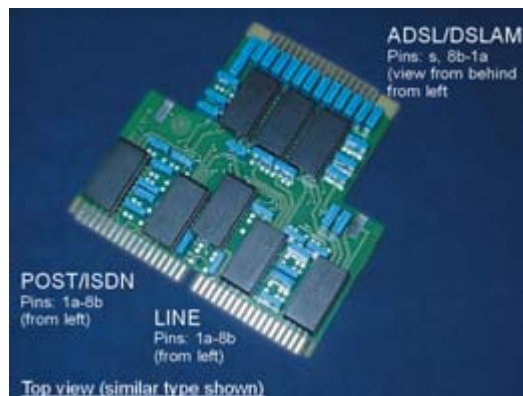
Karta splitera ADSL 8-portowa dla linii POTS i ISDN. Montaż w obudowie 32- lub 24-portowej
