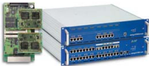
Rys. 2. Centralka abonencka z modulem routera, bramki VoIP i dodatkowymi procesorami dźwięku
